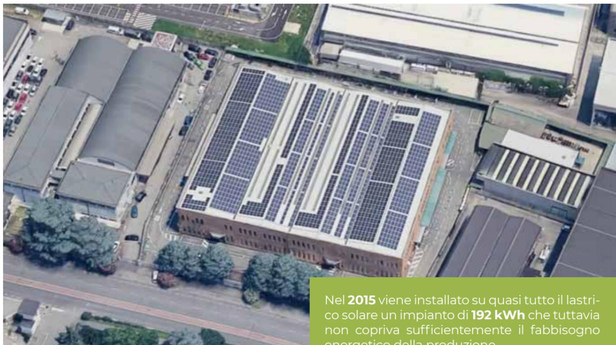
Nel 2015 viene installato su quasi tutto il lastrico solare un impianto di **192 kWh** che tuttavia non copriva sufficientemente il fabbisogno energetico della produzione. Per questa ragione nel 2023 abbiamo ampliato l'impianto ad una **capacità totale di 500 kWh** contribuendo attivamente alla sostenibilità ambientale e all'efficienza energetica. **Il potenziamento è entrato ufficialmente in funzione a settembre 2024 e ne vedremo i benefici nell'anno di rendicontazione 2025.**
